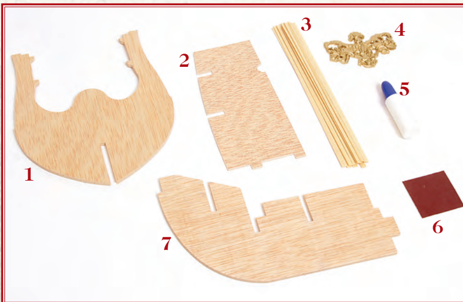
1 Spant 2. 2 Deckhälfte. 3 Holzstreifen, 0,6 x 5 x 200 mm. 4 Dekoration. 5 Holzleim. 6 Sandpapier. 7 Loskiel.
