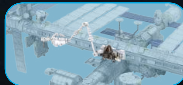
Le système de base mobile est une plateforme se déplaçant sur un rail le long de la station
