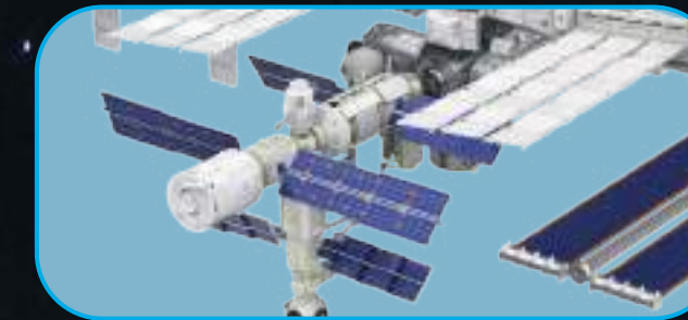
La passerelle du HRS Radiator et les panneaux solaires du Zvezda et du Nauka sont orientables
