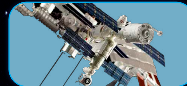
El puente del HRS Radiator y las placas solares del Zvezda y el Nauka pueden rotar
