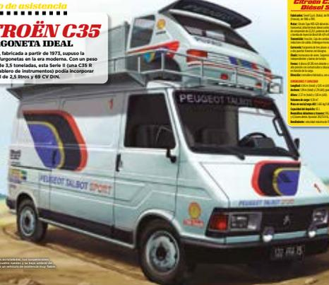
La Citroën C35, fabricada a partir de 1973, supuso la entrada de las furgonetas en la era moderna. Con un peso total en carga de 3,5 toneladas, esta Serie B, cuya C35 B con un nuevo tablero de instrumentos podía incorporar un motor diésel de 2,8 litros y 88 CV DIN.
