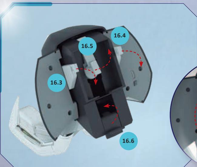
**121.o** Récupérez la tête du Dinozord Mastodonte et orientez les rotules **16.3** et **16.4** vers le bas, la pièce de connexion 2 **16.6** vers l'intérieur et la pièce de connexion 1 **16.5** avec son crochet vers l'extérieur. ◀
